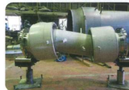
可とう管入れ替え時、既存変位に合わせて中間パイプに角度を付け、更なる変位を可能にした製品
