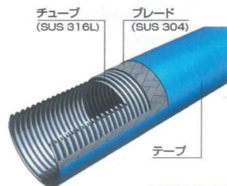
SDF管の 内部構造
