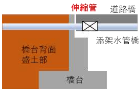
2024年能登半島地震での既設伸縮管の被害事例
