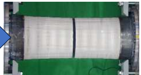
写真2 ペローズの伸長限界変位実験
