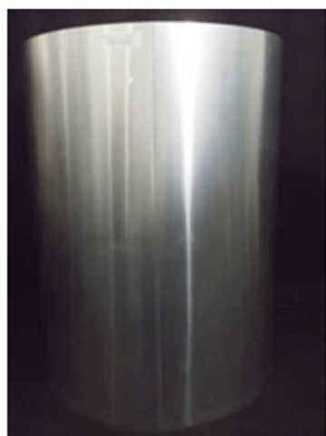
極薄肉アルミパイプ A5052 t0.3 口径φ670×926L
