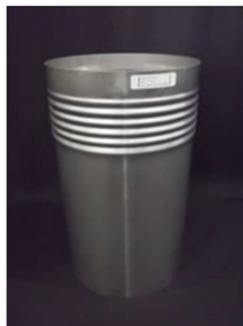
材質:SUS304 板厚:1.0mm 山高:4mm ピッチ:20mm
