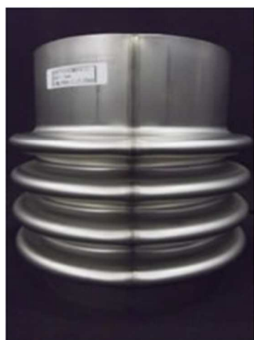
材質: TP270(純チタン) 板厚: 1.5mm 山高: 40mm ピッチ: 50mm
